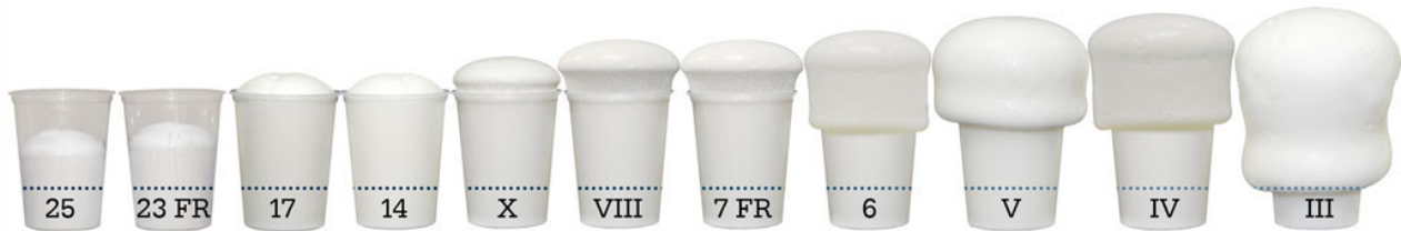
Ausdehnungsbeispiele von 250 ml fertig gemischten Schaums in einem ca. 1 Liter großen Becher
