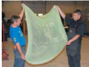
Nach 20 Minuten kann die Vakuumbaube entfernt werden.
