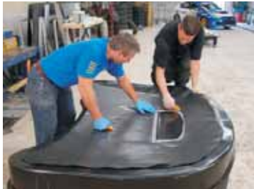
Der Verbundwerkstoff wird laminiert.
