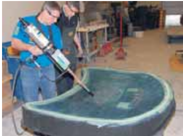
EZ-Spray Silicone 20 wird auf das Werkzeug gesprüht.
