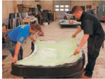
Die passgenaue Vakuumbaube wird aufgelegt.
