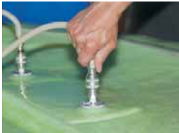
Unter Vakuum wird das Faserlaminat erstellt.
