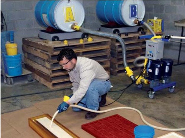
Die EZ-Mix Mischanlage ermöglicht schnelles und einfaches Mischen und Verarbeiten großer Mengen Kautschuk. Mit bis zu 14 Litern pro Minute können Gießkästen befüllt werden. Dadurch wird eine enorme Zeitersparnis bei der Betonformen-Herstellung erzielt. Durch die Möglichkeit, das Mischungsverhältnis anzupassen, können verschiedene Produkte verarbeitet werden. Ideal geeignet für unsere dünnflüssigen Polyurethane
