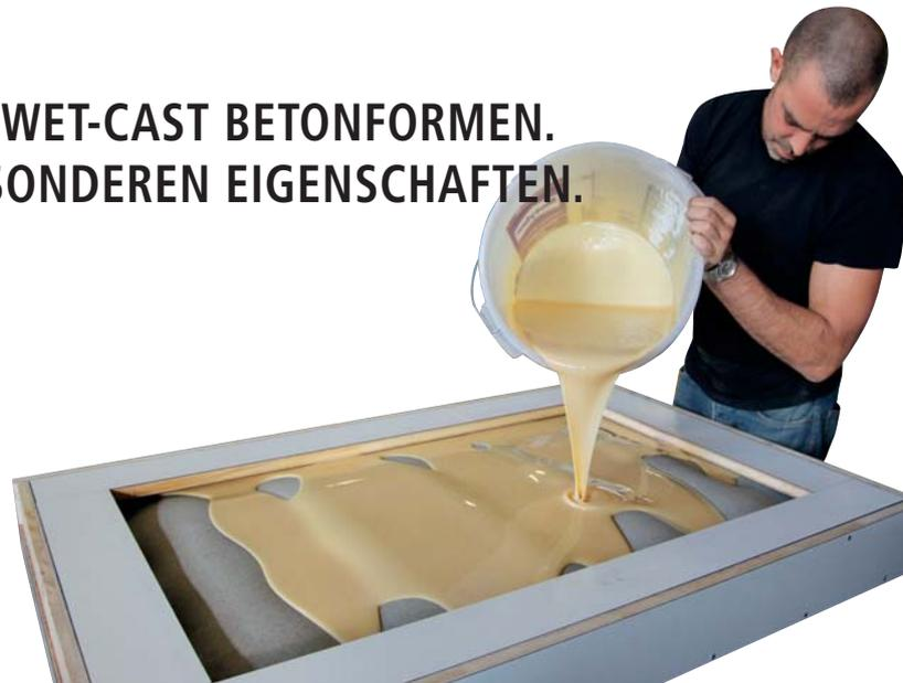
Mit unseren Materialien haben Sie die Freiheit bei der Formgebung, die Sie benötigen, um unverwechselbare Produkte herzustellen. Unterschiedlichste Formgebungen und Strukturen können durch das Betongießen in flexiblen Kautschukformen realisiert werden.
