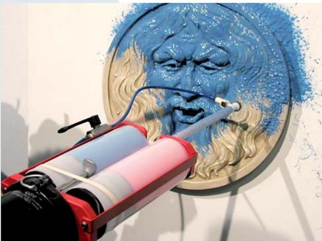
Für kleinere Projekte bieten wir unsere Sprühsilikone auch in Doppelkartuschen an. Mit der EZ-Spray® Jr. werden die beiden Komponenten automatisch per Luftdruck im Mischrohr gemischt und können direkt auf ein abzu-
