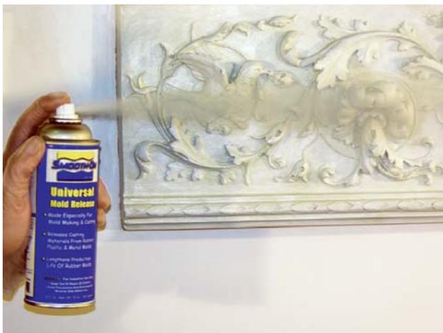
Speziell für den Formenbau entwickeltes, silikonhaltiges Trennmittel. Muss auf das Modell aufgetragen werden, bevor Polyurethankautschuk gegossen, gestrichen oder gesprüht wird. Aus der Sprühdose oder flüssig anwendbar.
