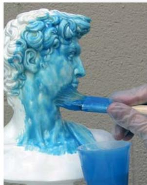
Brush-On® hält an vertikalen Oberflächen ohne zu tropfen und härtet bei vernachlässigbarer Schrumpfung zu einem widerstandsfähigen Kautschuk.
