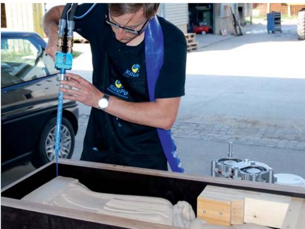
Die SilCon® Sprüh- und Mischmaschinen wurden entwickelt, um 2-K Silikone bequem und schnell zu verarbeiten. Dank des kleinen und leichtgewichtigen Mischkopfs ist die Handhabung sehr einfach. Zudem ermöglicht das automatische und luftblasenfreie Mischen noch hochwertigere Negativformen. Die SilCon® Maschinen können sowohl zum Gießen (Mold Star®) als auch zum Sprühen (EZ-Spray® Silicone) unserer Hochleistungs-Silikone verwendet werden.
